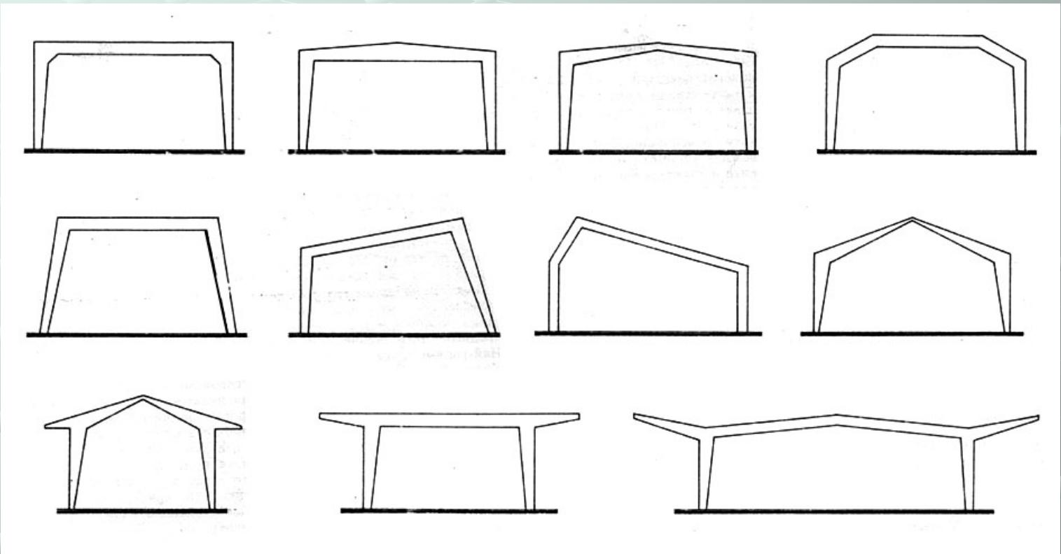
● Konstruktivne šeme poprečnih okvira
