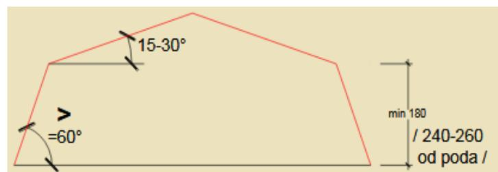
Za jedan zadati izgled poprečnog preseka mansardnog krova sa definisanim rasponima, visinama, uglovima nagiba krovnih ravni, položajem, brojem i dimenzijama stubova, potrebno je isprojektovati noseću konstrukciju sačinjenu od **AB elemenata** i **drvenih greda**.
