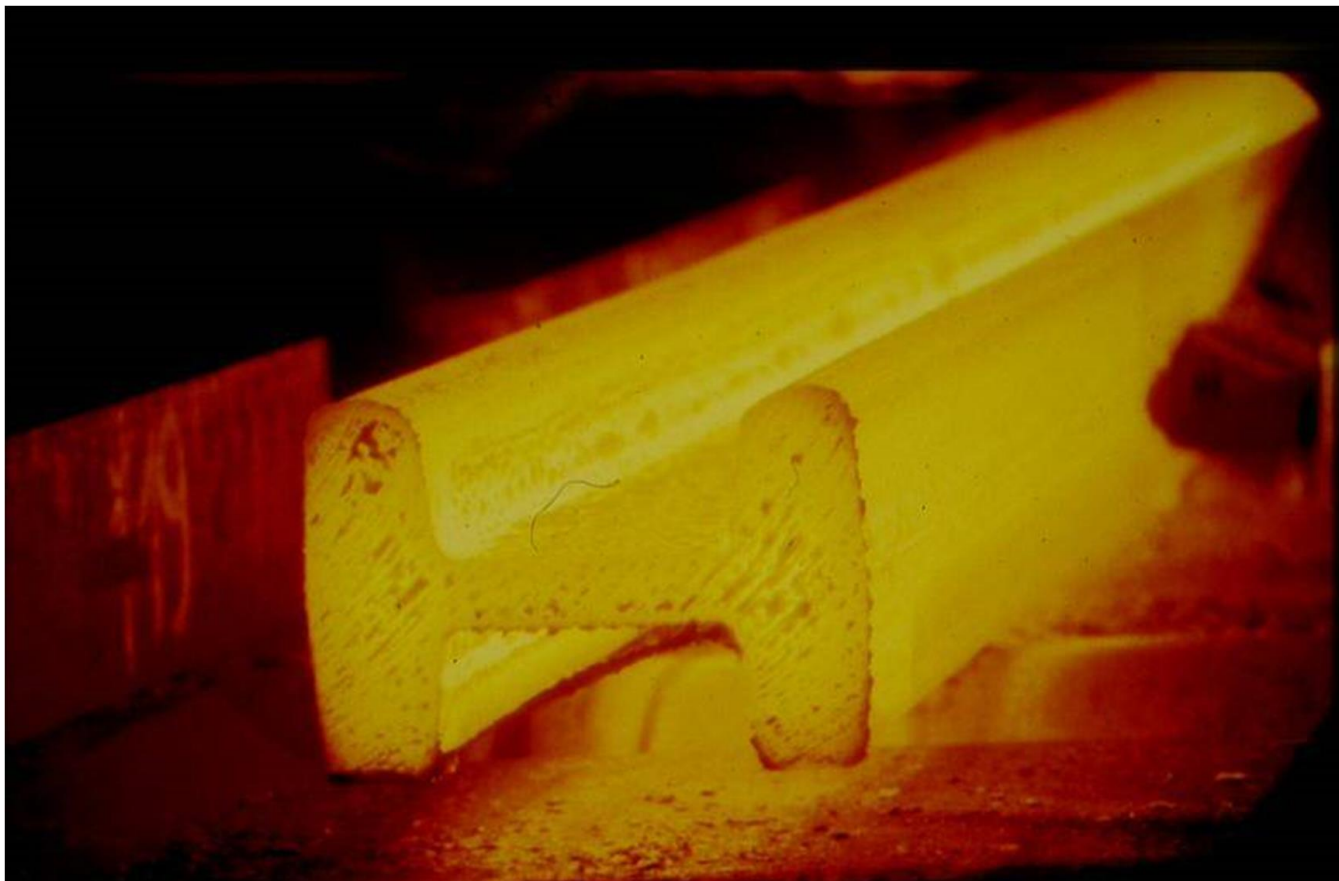
Slika 14. Valjanje I profilapomoću kalibrisanih valjaka
