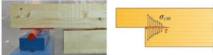
Слика 2.4 Пукотина и напони који узрокују њено отварање и пропацију
