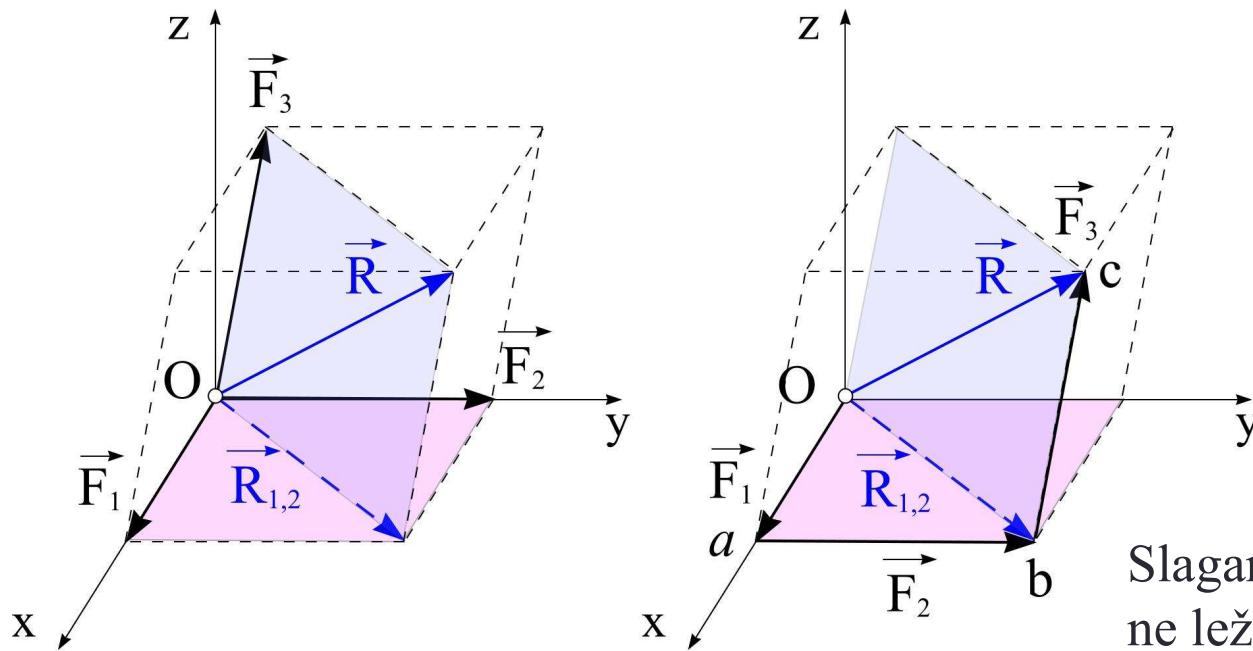
Slaganje tri sile koje ne leže u istoj ravni postupnom primenom **pravila paralelograma**.
