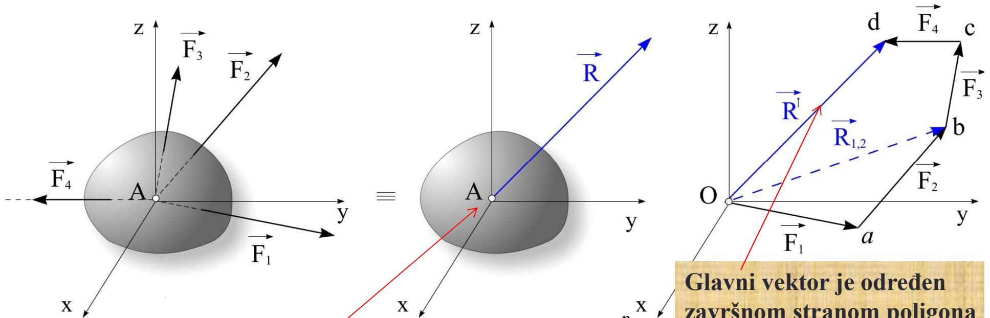
Prenošenjem glavnog vektora u napadnu tačku A sistema sila određena je njegova rezultanta  $\vec{R} = \vec{R}'$
