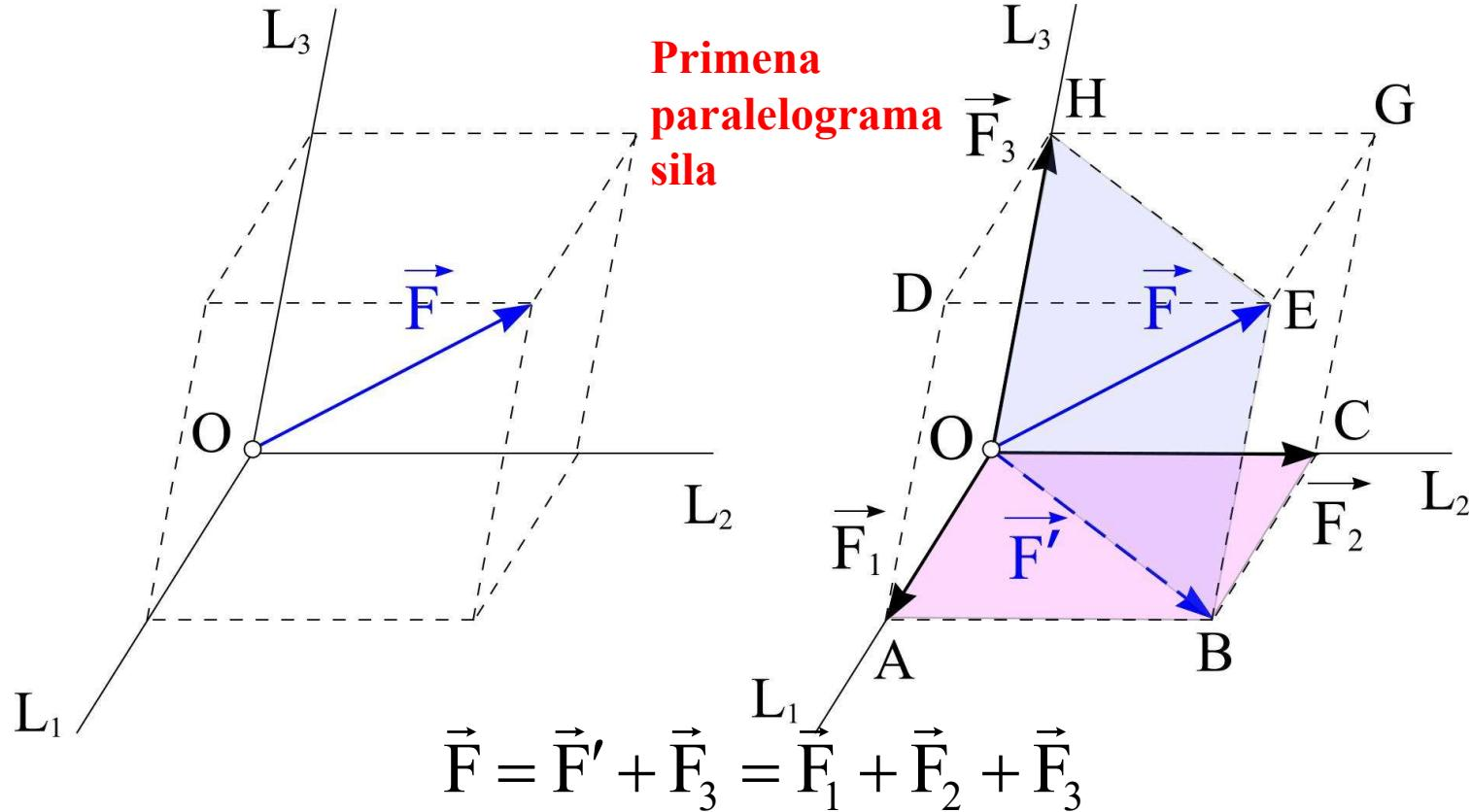
Razlaganje sile na tri pravca  $L_1, L_2$  i  $L_3$ , koji ne leže u istoj ravni geometrijskim postupkom - sila može prvo primenom pravila paralelograma da se razloži na komponentu koja leži u ravni  $OABC$  i komponentu na pravoj  $L_3$ , a zatim se komponenta razloži takođe primenom pravila paralelograma u prvcima  $L_1$  i  $L_2$
