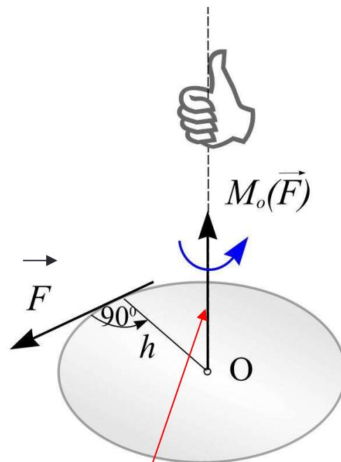
Moment sile u odnosu na tačku se ilustruje **kružnom linijom sa strelicom**, odnosno **kružnom linijom sa strelicom i vektorom**  $\vec{M}_o(\vec{F})$  da bi se razlikovao od vektora sile.
