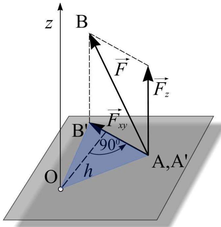
Moment sile za osu je pozitivan ako, gledano iz pozitivnog kraja ose, projekcija sile hoće da okrene telo **u smeru suprotnom od smera kazaljke na satu**, dnosno, ako se, gledano prema vrhu ose vidi obrtanje projekcije sile u smeru **dasnog zavrtanja**.
