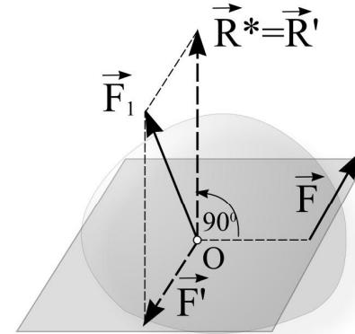
Dobijeni sistem koji čine sila i spreg sila koji su kolinearni zove se **dinamički zavrtanj** ili **dinama**, a prava duž koje je usmeren vektor  $\vec{R}^* = \vec{R}'$  naziva se **osu diname**.
