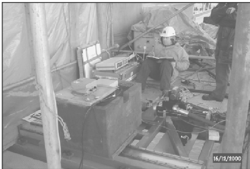
Hidraulični šejker sa opremom za horizontalno pobuđenje mosta
