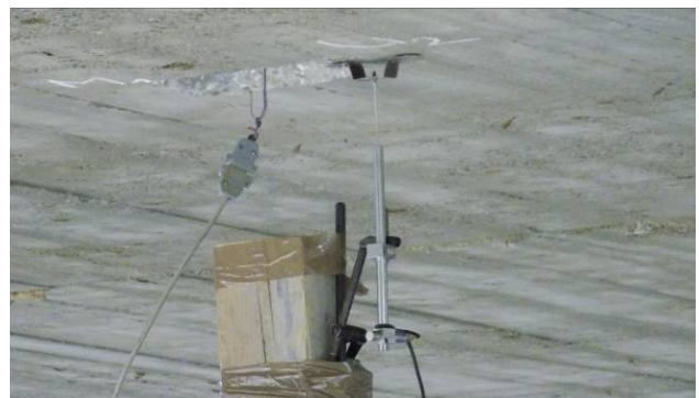
Slika 19: Položaj ugibomera (U2) i merne trake (M1) na ploči mosta u polovini raspona
