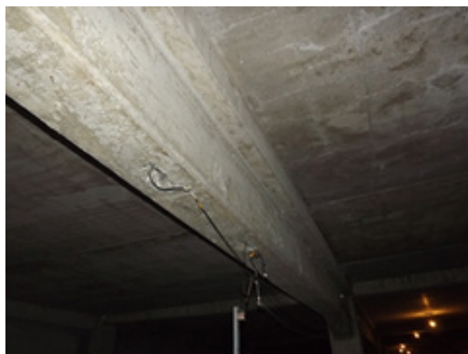
Slika 14 – Položaj mernih traka M3 i M
