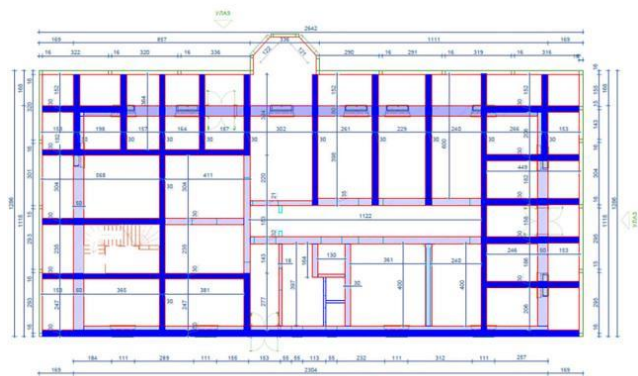
Slika 6. Rekonstruisano stanje Kraljeve vile: Osnova saniranih i rekonstruisanih zidova prizemlja
