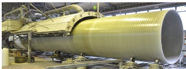
Slika 1 – Kontinualni postupak namotavanja [4]
