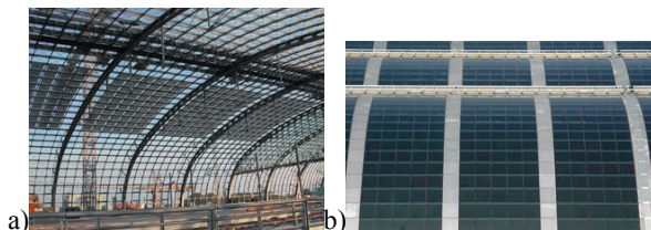
Slika 7 – a) Polikristalni moduli na železničkoj stanici Lehrter u Berlin, b) Fotonaponske ćelije u obliku tankoslojne folije na krovu renovirane Stilluell stanice u Njujorku
