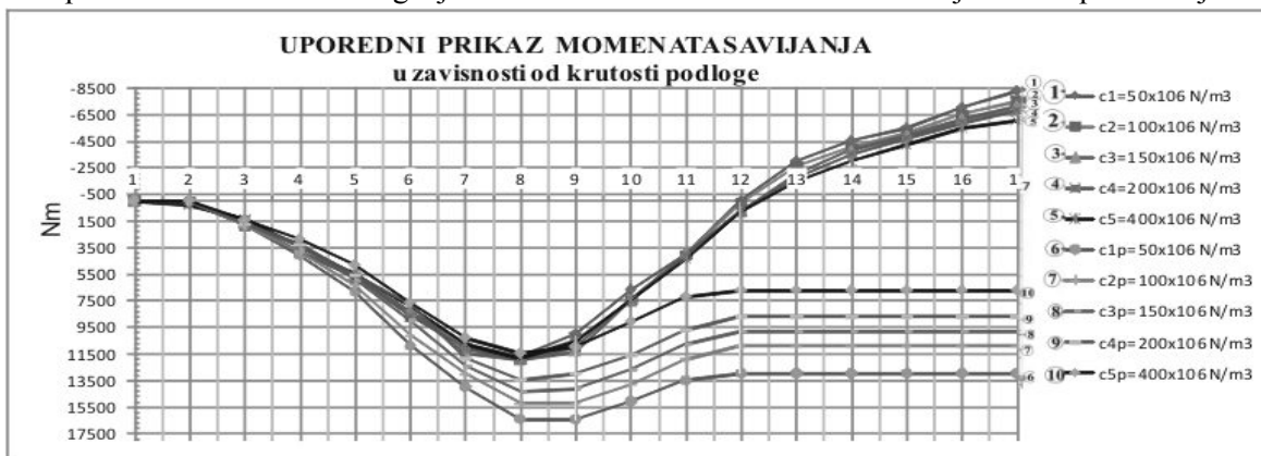
Sl.2. Uporedni prikaz momenata savijanja u pragu, pre i posle podbivanja, dobijenih MKE analizom za krutosti podloge od c_1=50 \times 10^6 \text{ N/m}^3 do c_5=400 \times 10^6 \text{ N/m}^3
