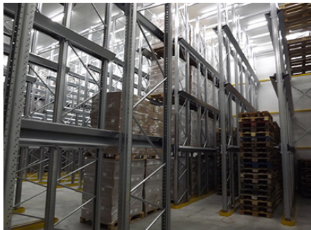
Slika 9 – Nanošenje opterećenja - Faza opterećenja Ib
