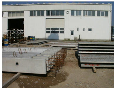
Slika 3 – Stubovi i međuspratna konstrukcija Omnia u pogonu Putinženjeringa
