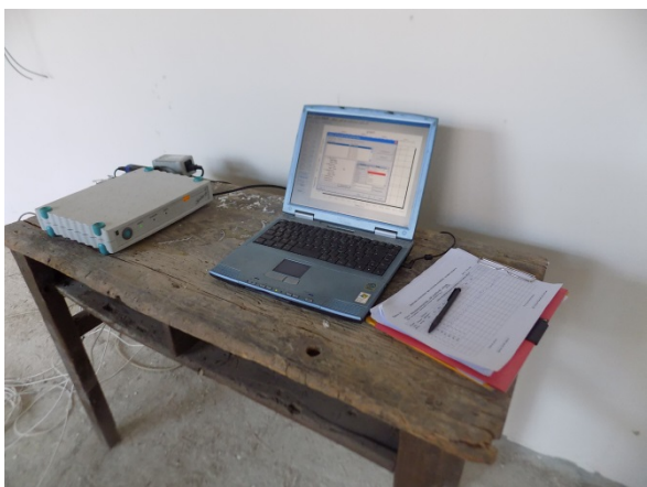
Foto 3 – Merna stanica (akvizicijski sistem SPIDER 8 povezan na PC)
