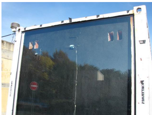
Slika 6 - Eksperimentalna studija termičkih karakteristika Trombovog zida
