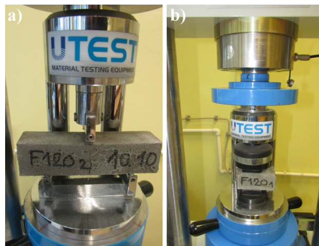
Slika 2 – Ispitivanje čvrstoće pri savijanju maltera (a); ispitivanje čvrstoće pri pritisku maltera (b)
