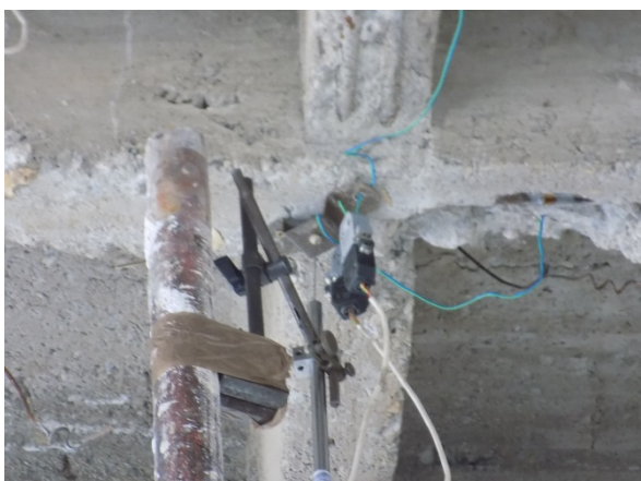
Foto 2 – Položaj LVDT – ugibomera u L/2 (U1) i merne trake na armaturi (MT1)
