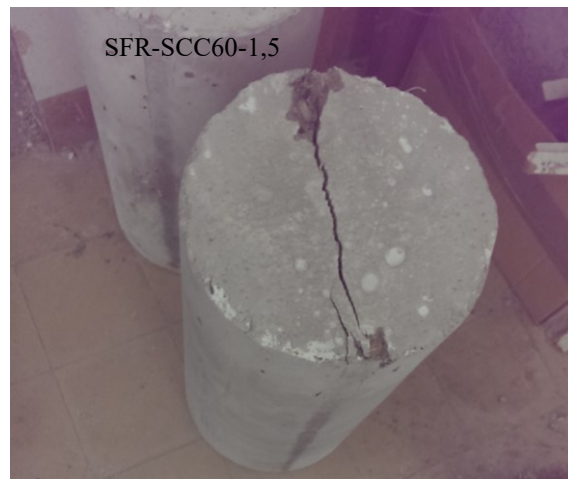
Slika 8 – Uzorak SFR-SCC60-1,5 nakon ispitivanja čvrstoće pri zatezanju cepanjem
