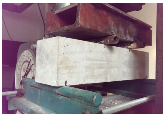
Slika 4 – Ispitivanje čvrstoće pri savijanju
