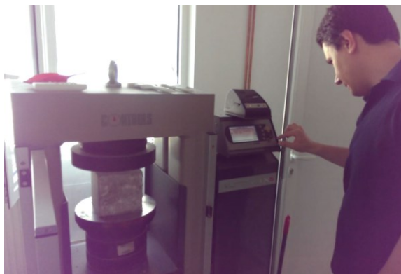
Slika 2 – Ispitivanje čvrstoće pri pritisku
