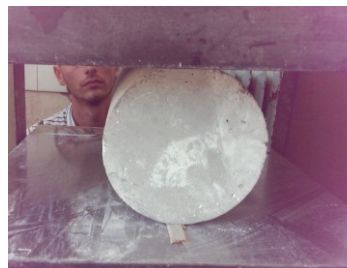
Slika 3 – Ispitivanje čvrstoće pri zatezanju cepanjem
